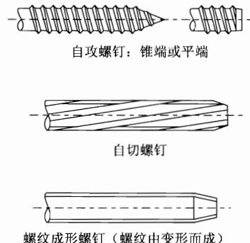
图 22 自攻螺钉、自切螺钉和螺纹成形螺钉的例子
