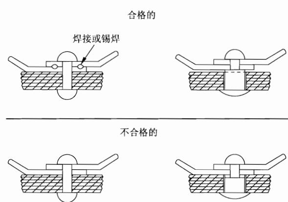
图 17 电气连接件结构图
