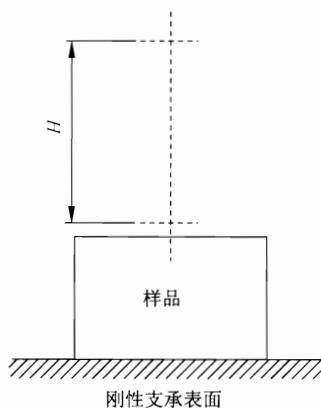
注：进行侧面的冲击试验时，刚性支承表面应垂直安置。
