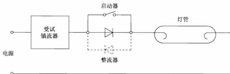
图 C.2 整流效应的试验线路(单脚灯管的镇流器)
