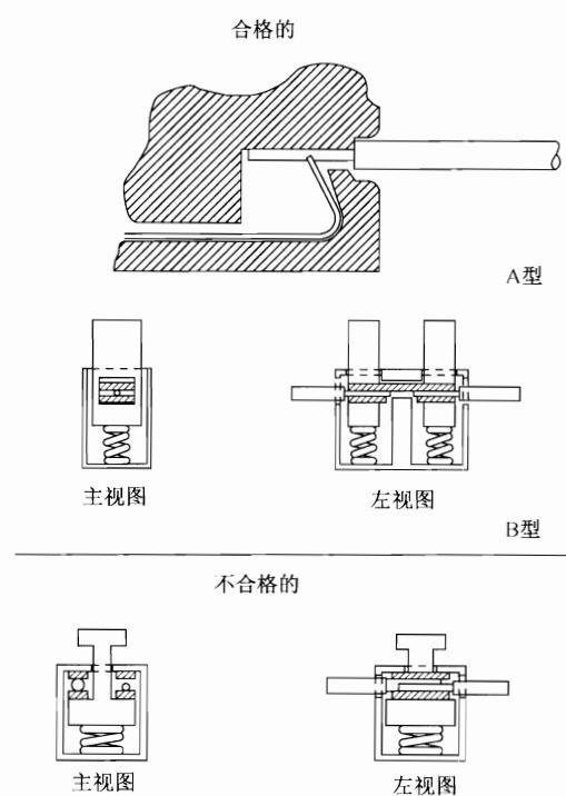
图 18 弹簧式无螺纹接线端子的例子
