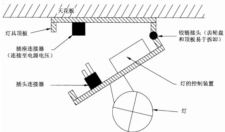
图 31 插头/插座连接的电气-机械接触系统
