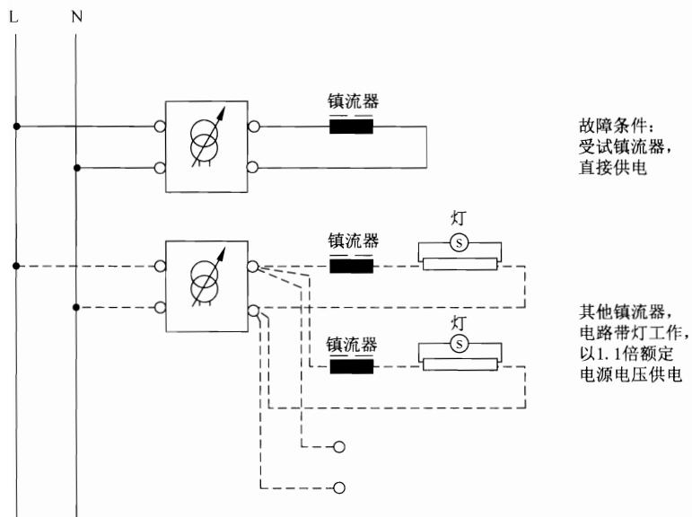
图 32 内含 $\leq 70\text{ W}$  荧光灯的灯具的试验电路
