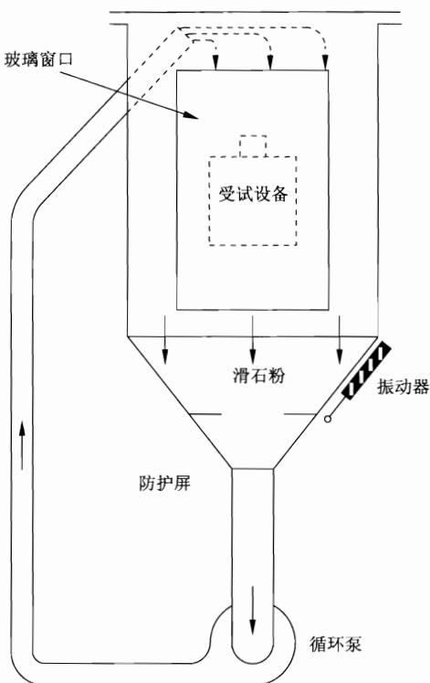
图 6 防尘试验装置
