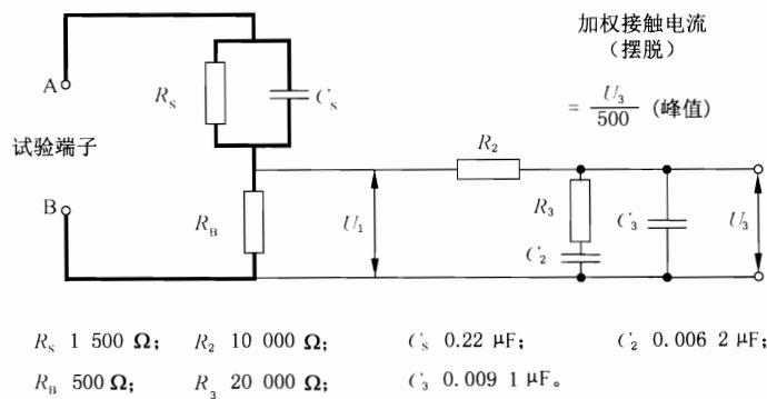
图 G.3 摆脱加权接触电流的测量网络
