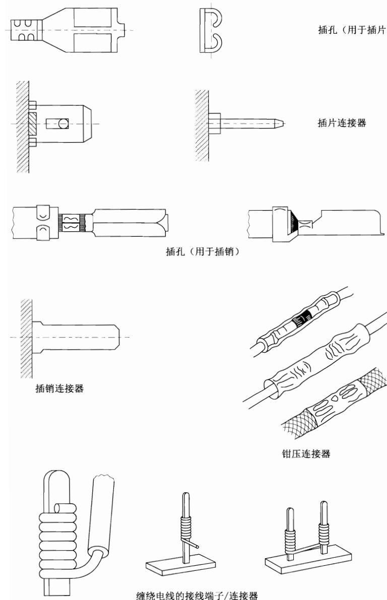
图 19 无螺纹接线端子/连接器的其他例子
